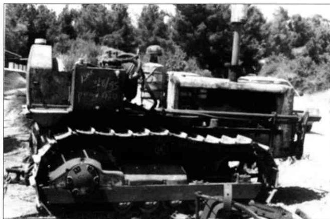
את הטרקטור הזה (כאשר קיבלתי אותו) התנעתי בגרירה על מנת לעלות על המשאית, משום שהמנוע הקטן היה תפוס אחרי שחדרו מים לצילינדרים דרך הפלגים. על מנת לטפל במנוע צריך היה לפרקו לגמרי ולהוריד אותו מהטרקטור.
