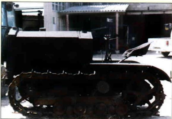
בתמונה: טרקטור זחלי מסוג CLETRAC, שנת יצור 1930, לפני השיפוצ
