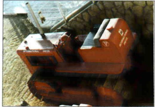
הפעם אכתוב על שיפוצו של טרקטור זחל מסוג אינטרנציונל דיזל TD9 משנת יצור 1947 בעל הספק מנוע של 45 כוחות סוס, שהיה נפוץ מאד בקיבוצים ובמושבים בארץ מסוף שנות ה-40 ועד אמצע שנות ה-60. מדובר בטרקטור שהגיע למוזיאון קיבוץ יפעת משדות קיבוץ גניגר לאחר שעמד שנים בגשם ובבוץ, תפוס תפוס בשרשרות ובמנוע בגלל חדירת מי-גשם. את הטיפול הראשוני התחלתי במקום עמידתו (תמונה מימין) כאשר פירקתי את חלקו האחורי (מכל דלק וכנפיים) על מנת להגיע למערכות הבלמים וההיגוי. בפנים הכל היה חלוד ותפוס. הייתי חייב לרסס עליו
