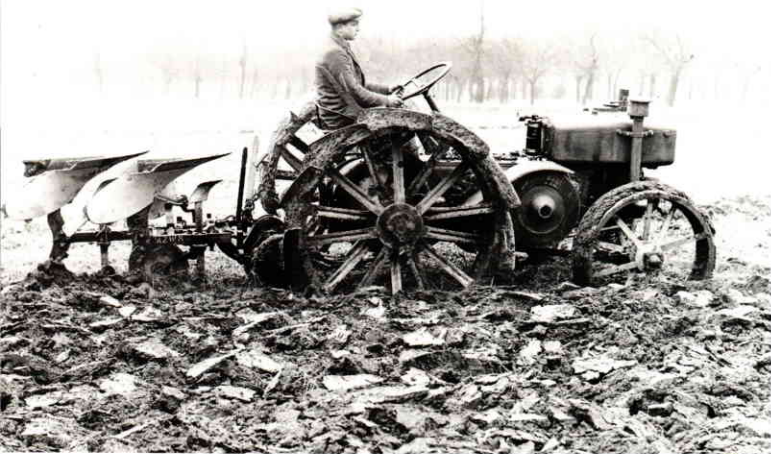
החל משנת 1923 מייצרים במרצדס-בנץ טרקטורים עם מנוע דיזל. בתמונה: אב־טיפוס מבצע "נסיעת מבחן" עם מנוע דיזל דו־בוכנה, 4 פעימות ו־25 כוח־סוס, ביוני 1922
