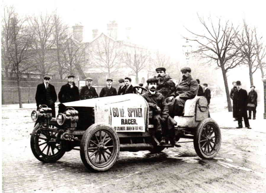
הספייקר 60HP משנת 1902 הייתה מכונית מרוץ מהפכנית שיוצרה בהולנד, ונחשבת כיום כרכב כפול-הנעה הקונבנציונאלי הראשון, המונע באמצעות תיבת העברה וגלי הינע. המותג ספייקר, אגב, קם לתחייה לפני שנים אחדות תחת מכוניות ספורט אליטיסטיות ויקרות להחריד
